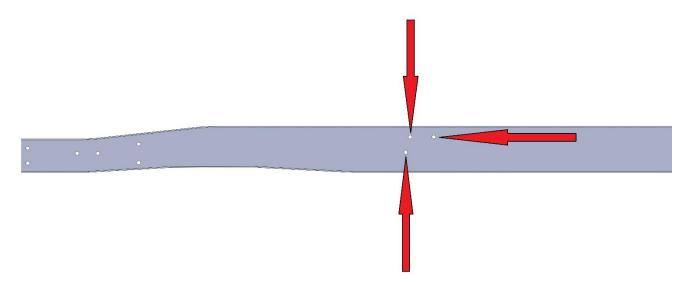
USE FACTORY RIVET HOLE CENTERLINE TO MARK FOR CUTTING OF FACTORY FRAME RAIL
