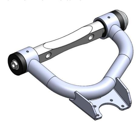
AFTER BUSHING IS SEATED FLUSH AGAINST MACHINED SURFACE OF TUBE, INSTALL THE BUSHING RETAINER AND BOLT. WHEN TIGHTENING THE RETAINER NUT, YOU WILL FEEL WHEN THE RETAINER BOTTOMS OUT ON CONTROL ARM SHAFT SHOULDER. TORQUE TO 25 LBS. (LOCTITE IS ALSO RECOMMENDED FOR FINAL ASSEMBLY)
